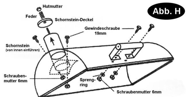
11. Befestigen Sie die BBQ-Scout-Logoplatte auf der rechten Seite der Grillhaube mithilfe der beiden Sprengringe und Schraubenmutter.
