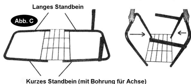
Achten Sie unbedingt darauf, dass die **Beschriftung auf der Querstrebe** nach außen gerichtet ist und der **Pfeil** auf der Querstrebe nach unten (zur Ablageplatte) zeigt.
